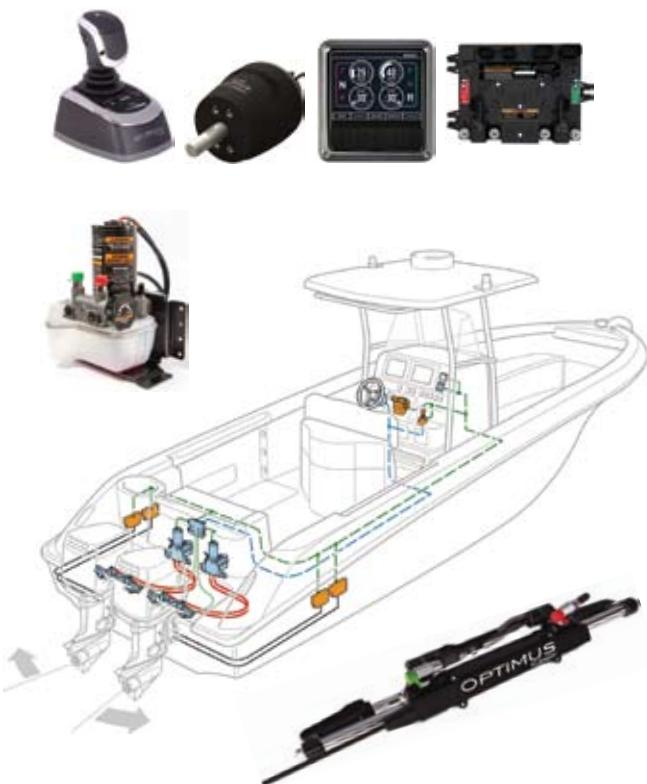
Motori sa mehaničkim gasom i kopčom koriste Dometic elektronske komande i7800.
